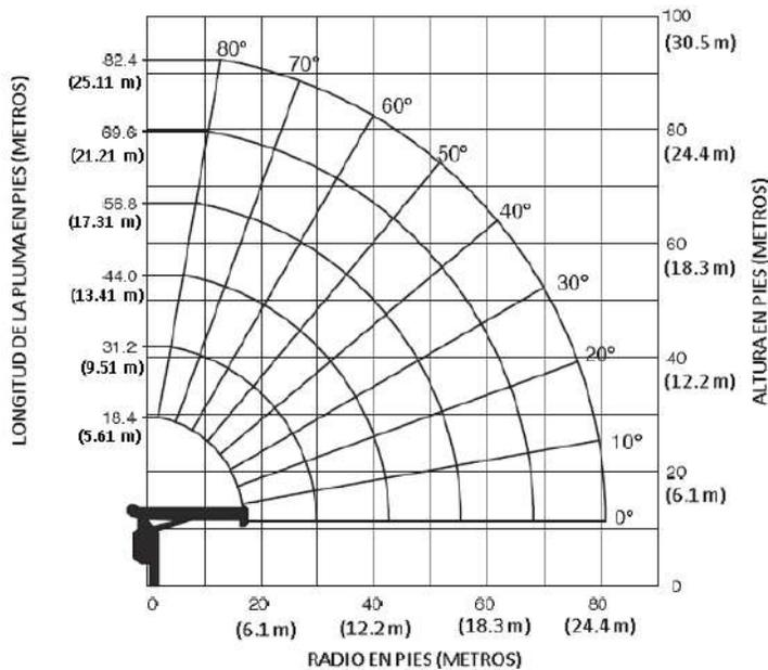
La elevación y el ángulo de la pluma están basados en el brazo recto y sin accesorios y debe tener en cuenta que se obtendrá una deflexión en el brazo de la pluma en la condición de carga.
